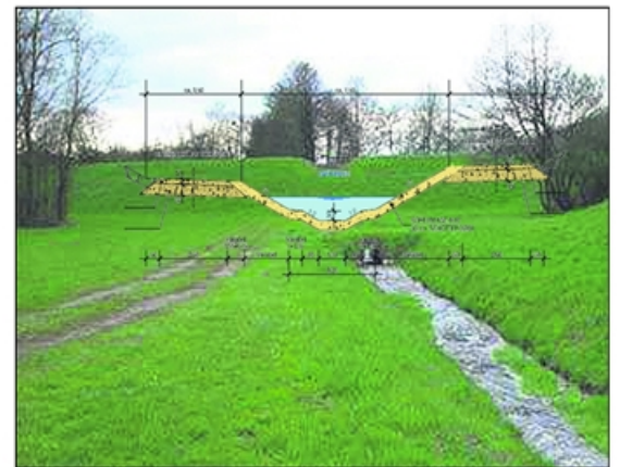
... bekommt aber einen trapezförmigen Durchlass für den Hochwasserfall.
